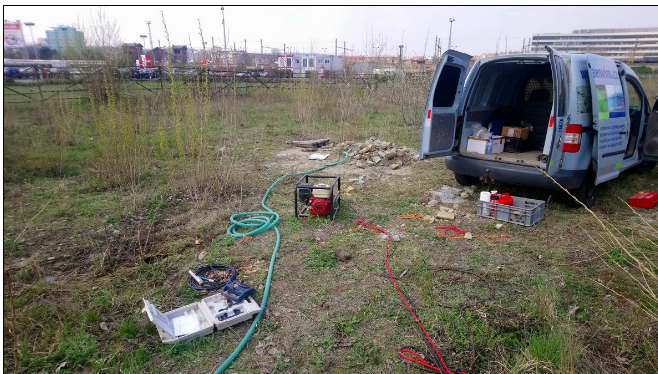
Obr.4: Realizace čerpací zkoušky na vrtu V5
